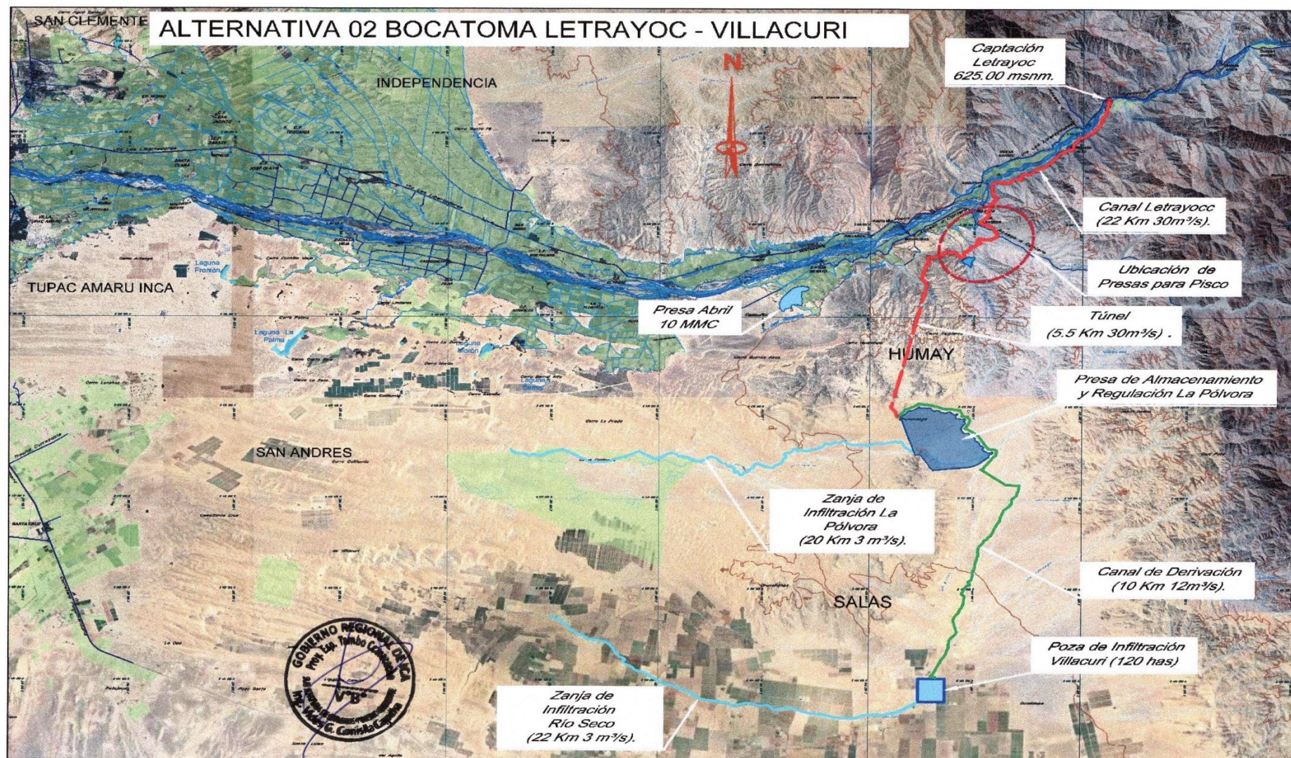
FIGURA N° 07: ESQUEMA DE SOLUCION ALTERNATIVA 2
