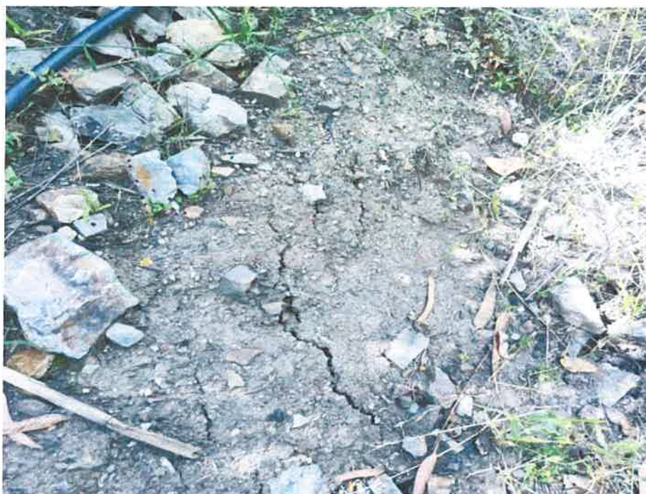
Imagen N° 10: Área N°03, presencia de grietas de tensión debido a la reptación de los suelos a consecuencias a consecuencias de la presencia de aguas residuales.
