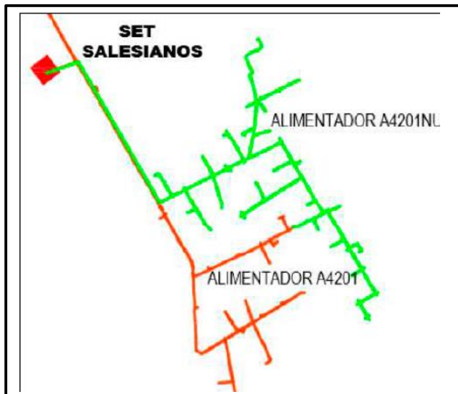
Fig. N° 11: Redes finales en 10 kV después de la reconfiguración y división del alimentador A4201
