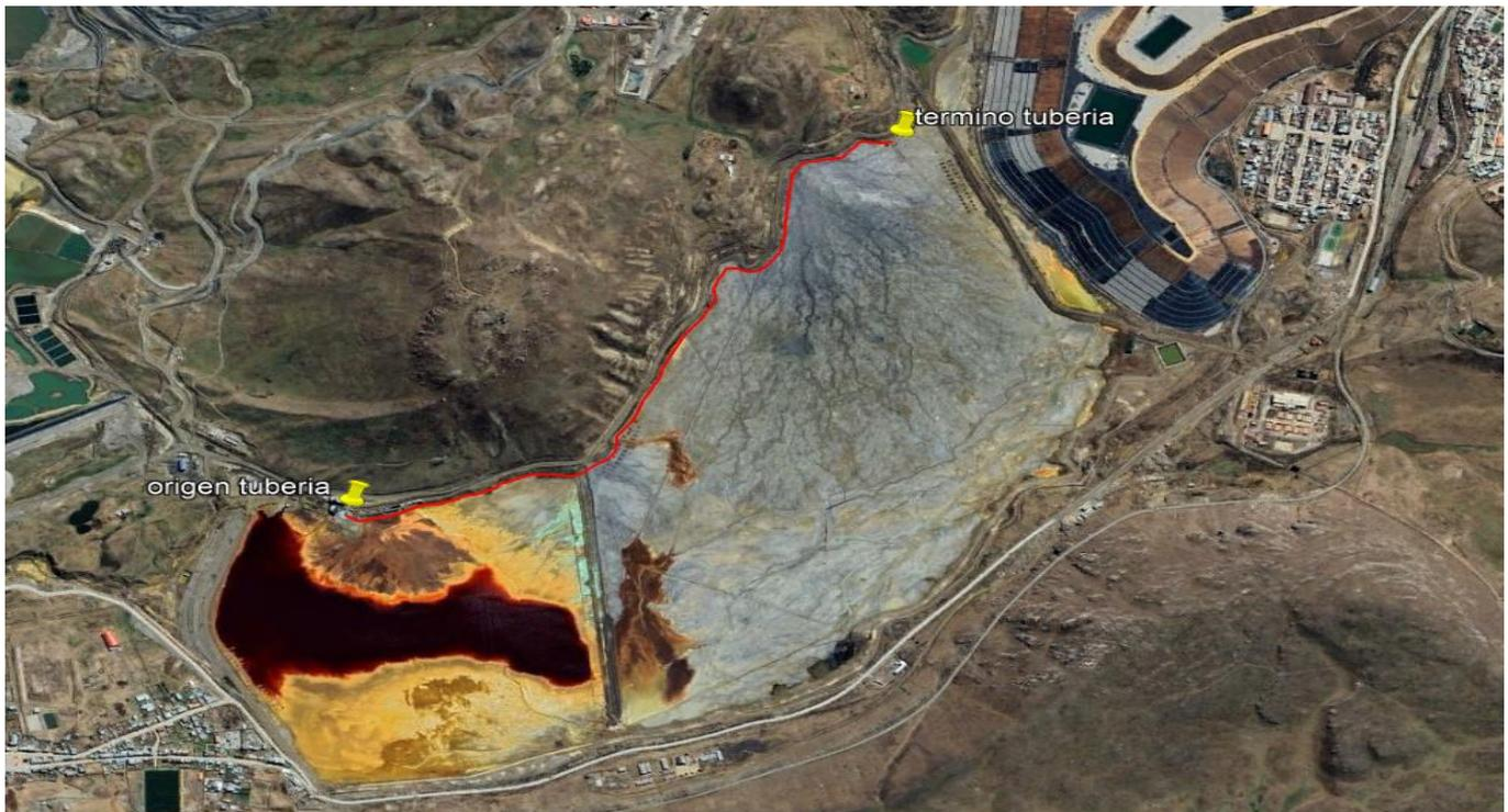
Imagen satelital – ubicación de la línea de tubería
