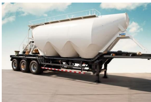
Imagen referencial de una cisterna de transporte de solido a granel en semirremolque.
