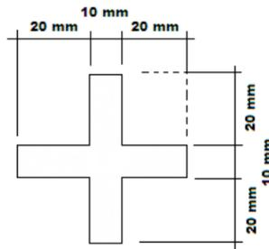
2. BM's y Poligonal de Apoyo: Monumentación en concreto de manera fija (la base será circular con un diámetro mínimo de 10" y profundidad según el terreno no menor a 0.40m) con una varilla de fierro de  $\frac{1}{2}$ " de longitud 0.30m, que sobresalga 1 cm.
