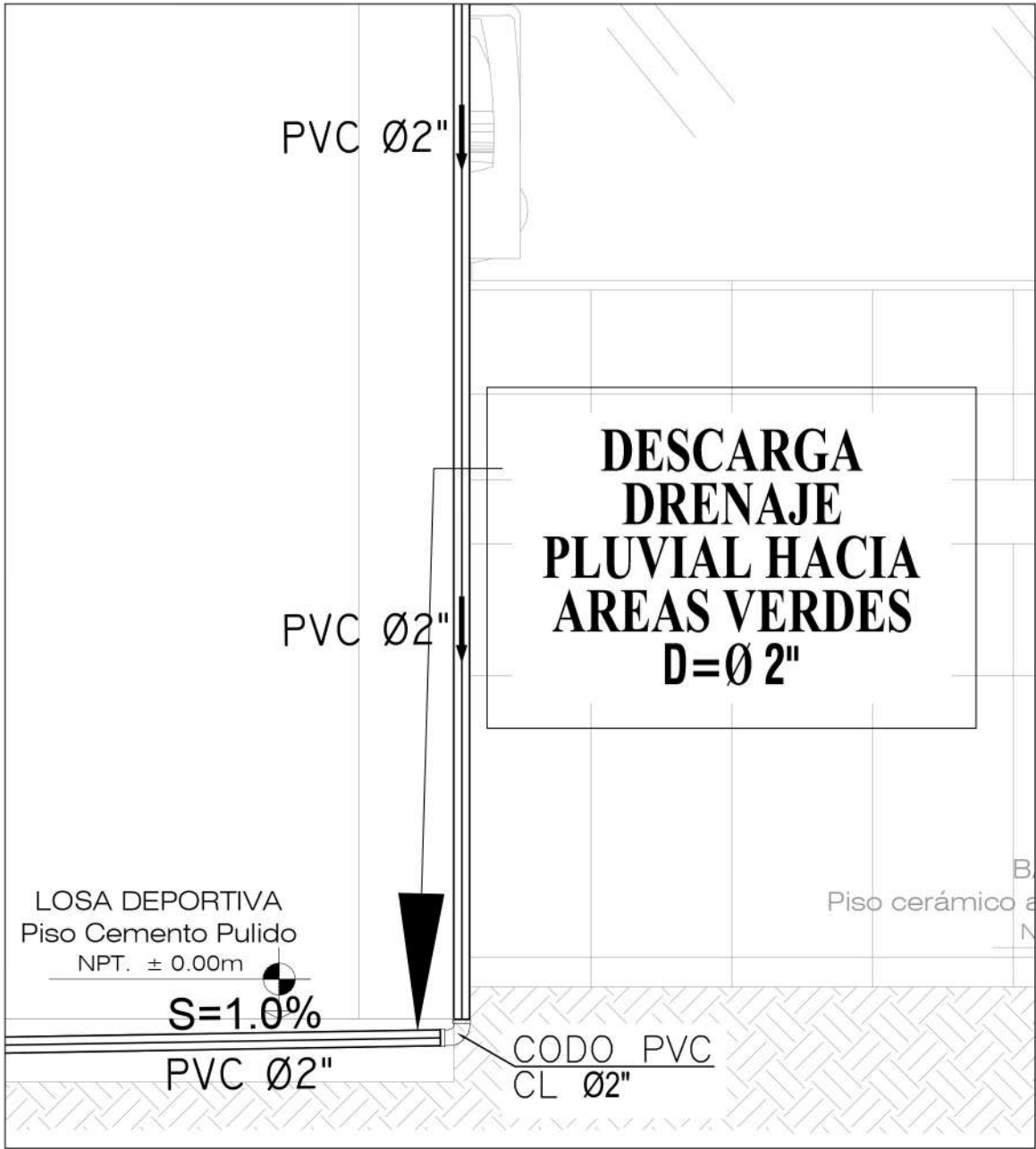
DETALLE: MONTANTE DE DRENAJE PLUVIAL - DIRECTO A CANALETA DE DRENAJE
