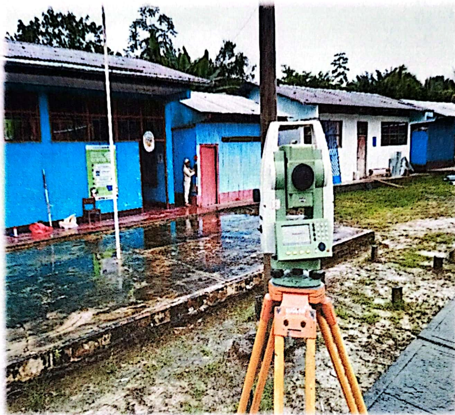
Foto N° 03: Vista de la localidad de Nuevo Capanahua realizando levantamiento topográfico al detalle de veredas, lotes, buzones, etc.
