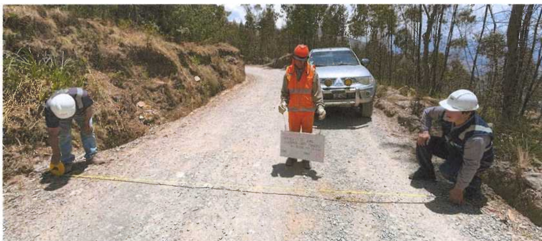
Fotografía N° 54– Km. 13+250 ancho de la calzada
