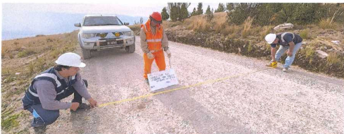
Fotografía N° 80– Km. 19+750 ancho de la calzada
