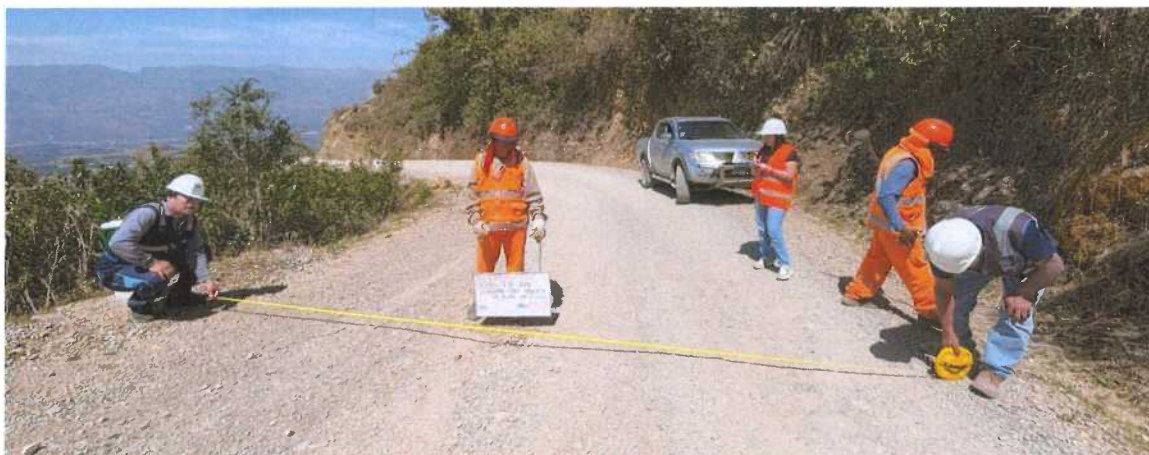
Fotografia N° 37– Km. 09+000 ancho de la calzada
