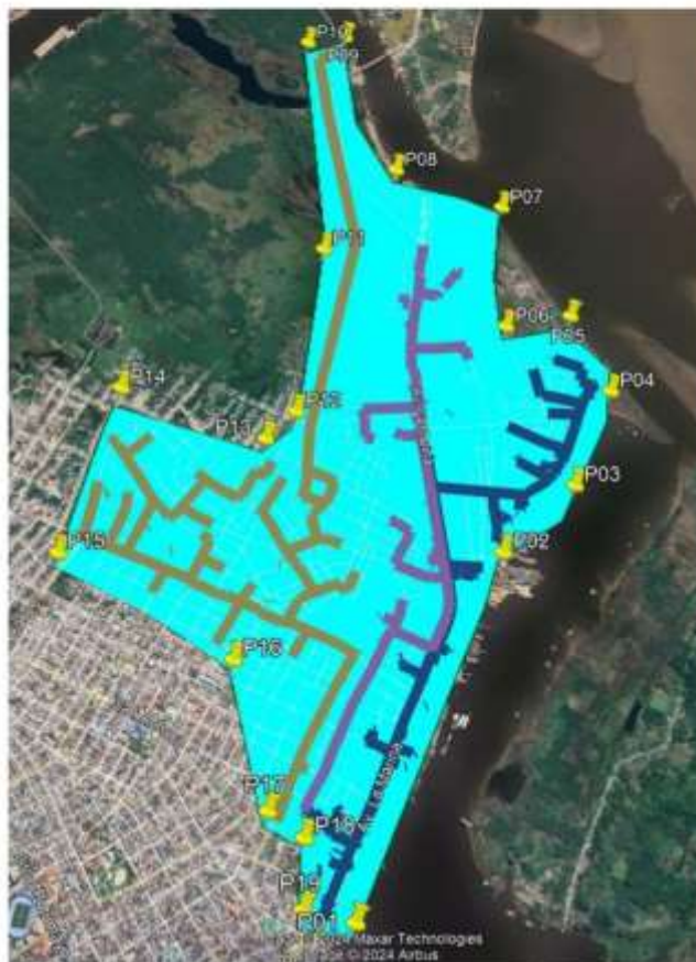
Figura N.° 1: Área de influencia del proyecto con los alimentadores S4, S1 y S11 conectados a la SET térmica de Iquitos.
