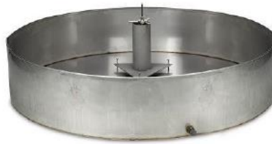
Ilustración 2. Tanque evaporímetro Clase A
