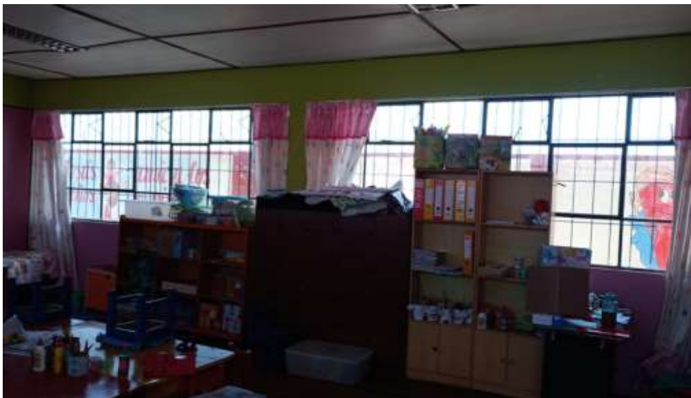
Fotografía 06: Vista interior del aula 01. Se aprecia las ventanas de marco de hierro con vidrio simple, así como el falso cielo raso de triplay con las luminarias empotradas en regular estado de conservación.
