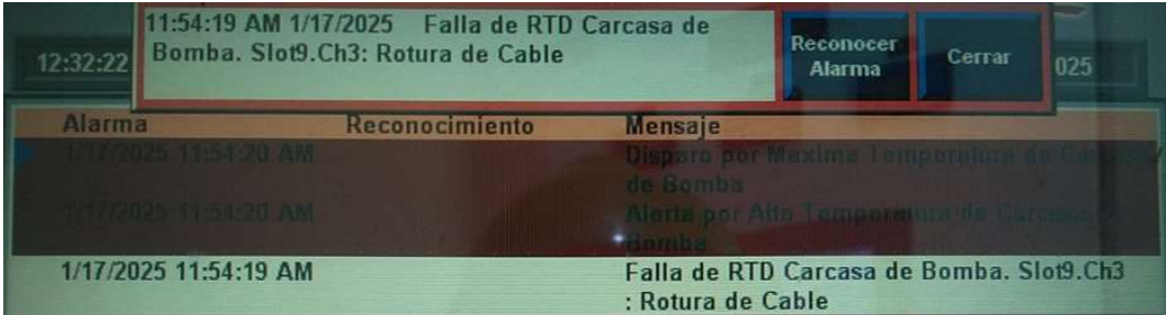
Figura 14. Observación por fallas en la señal de sensores de temperatura en pantalla HMI de 1MB3.
