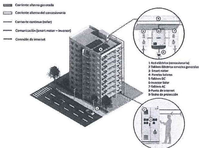
Figura 3: Representación gráfica de todos los componentes del sistema fotovoltaicos
