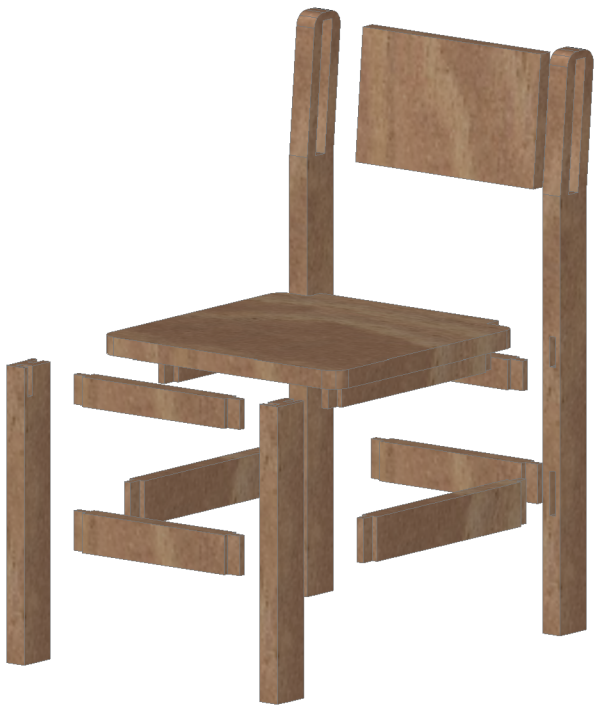
DETALLE DE UNIONES ESCALA 1 : 10
