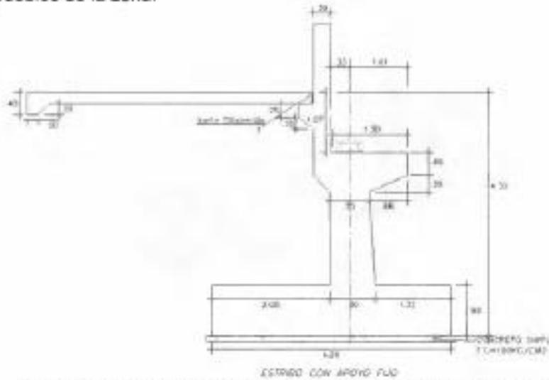
Se detalla en el siguiente plano de detalles mínimos del estribo.
