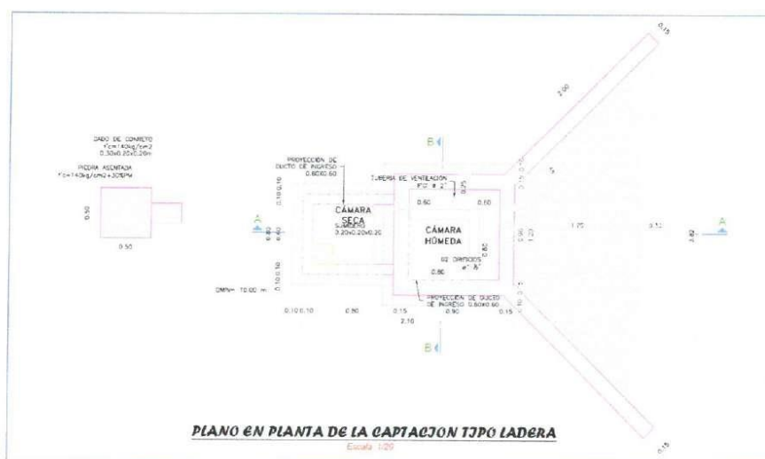
Imagen N°41 Captación Tipo Manantial de Ladera
