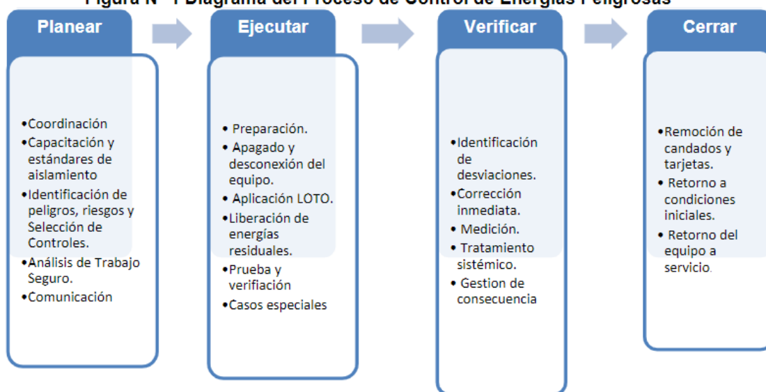
Figura N° 1 Diagrama del Proceso de Control de Energías Peligrosas
