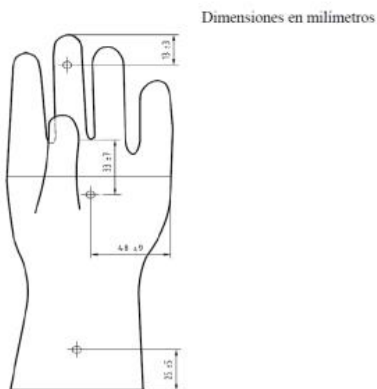
Figura referencial: Puntos de medición para espesor del guante
