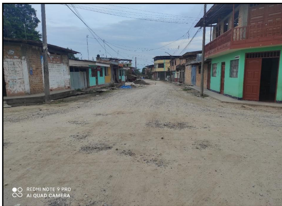
Jr. Ricardo Palma C 08 – No cuenta con drenaje pluviales, y se nota en las partes laterales de la calzada, las erosiones que provocan las aguas de lluvia acumuladas.
