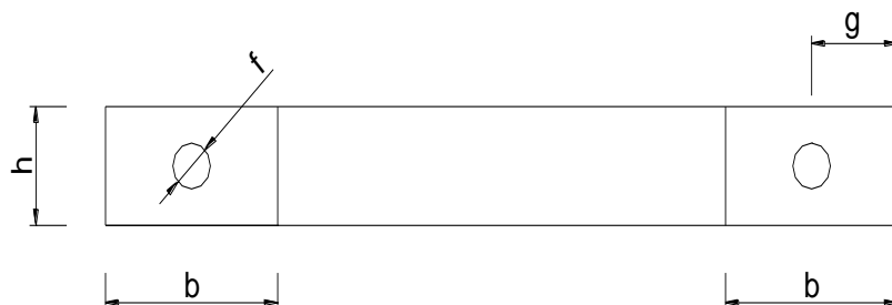
PLANO REFERENCIAL DE ABRAZADERAS DE RIOSTRA
