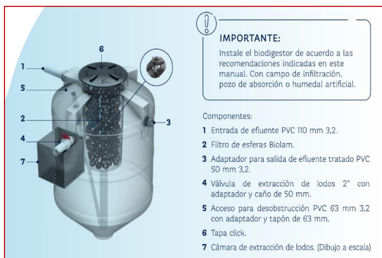
IMAGEN N° 11: COMPONENTES DEL BIODIGESTOR
