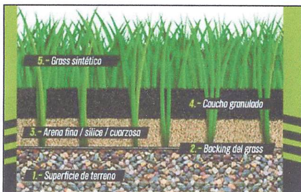
Imagen N°02. Estructura de la sección en la instalación de Grass sintético.
