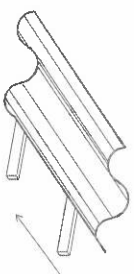
DETALLE DE SENTIDO DE INSTALACION DE CALAMINA GALVANIZADA 0.14mmx1.80mx.080m
