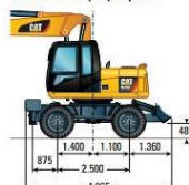
Tren de rodaje con 1 juego de estabilizadores y hoja topadora
