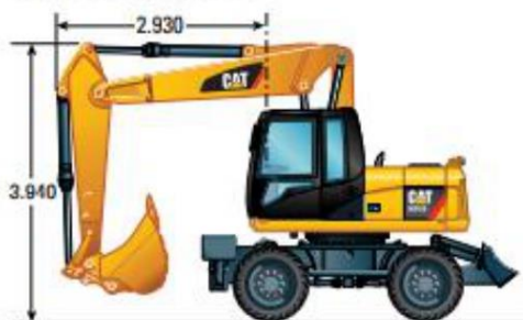
Posición de desplazamiento por carretera con brazo de 2.300 mm
