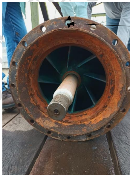
Distancia entre pestaña y extremo de brida
