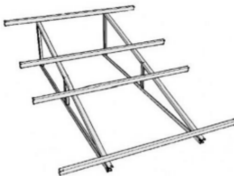
Figura 10. Imagen referencial de estructura metálica para panel solar
