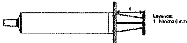
Figura referencial N° 3: Longitud mínima entre las alas de sujeción del cilindro y el disco de empuje del émbolo
