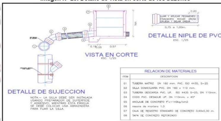
Imagen N° 25: Detalle de vista en corte de los buzones
