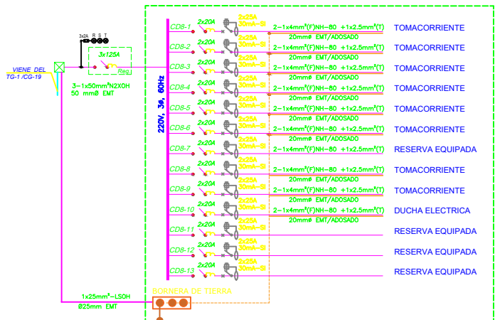
ESQUEMA UNIFILAR DE SUB TABLERO TOMACORRIENTE (TD-PISO 9),IP-65, EMPORADO.
