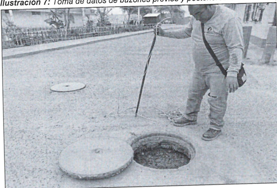
Ilustración 7: Toma de datos de buzones previos y posteriores al tramo colapsado
