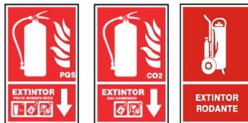
Imagen N°01: Modelo de Señales para extintores estacionarios y rodantes Nota: Para el caso del extintor tipo HL-I se podrá utilizar una señalética genérica.
