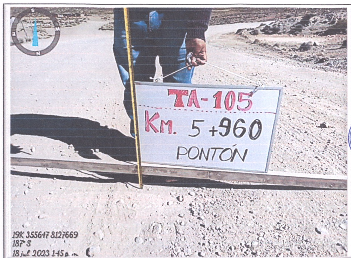
FOTO N° 21: Verificando la profundidad de fallas por Erosión y ahuellamientos por tránsito de maquinaria y vehicular (Baches), Km. 5+960
