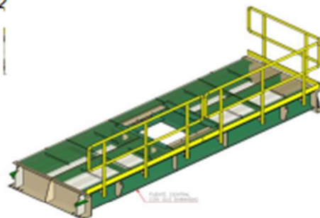
Fig. N°09 Puente central del Tanque de neutralización, con barandas
