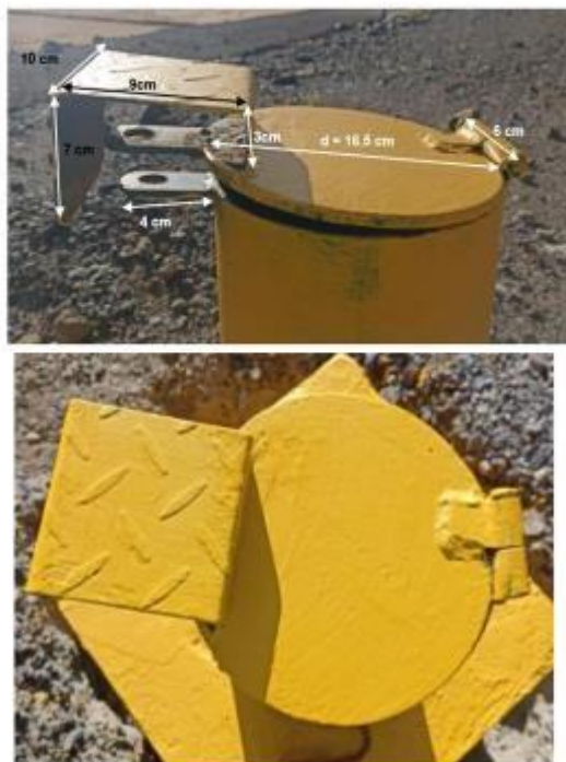
Medidas de la tapa del piezómetro GW-5(A/B)
