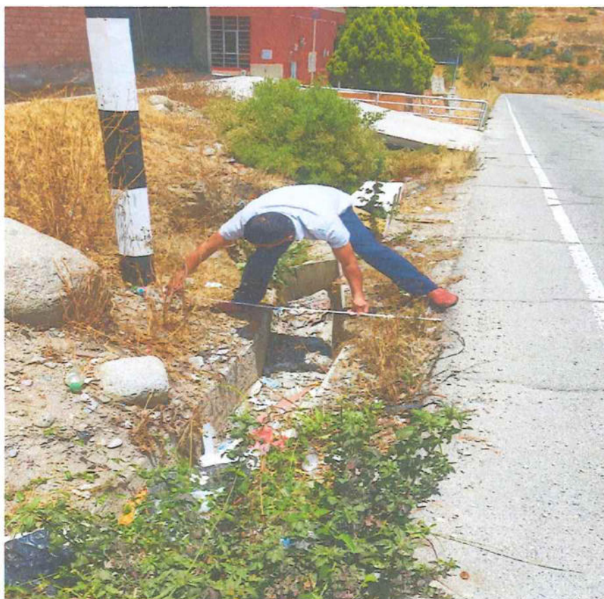
Imagen 06: Se observa la sección de la cuneta.
