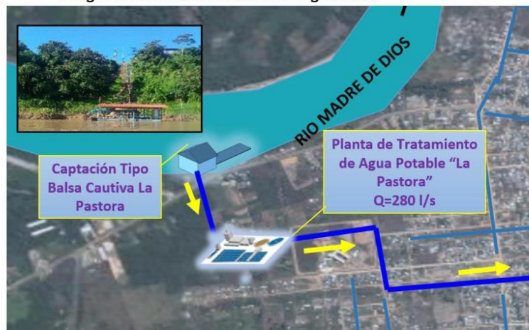
Imagen 7: Línea de conducción de agua cruda
