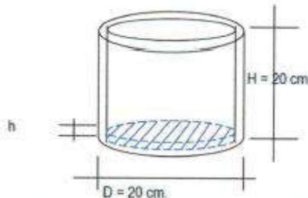
Para medir la cantidad de agua, se deberá introducir una regla milimetrada de madera en el centro del balde y se procederá a la medición respectiva.
