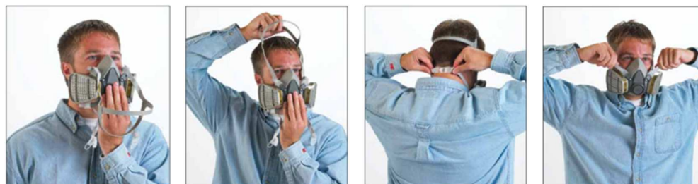
Figura 11. Procedimiento para colocación del protector respiratorio (respirador con cartuchos/filtros)
