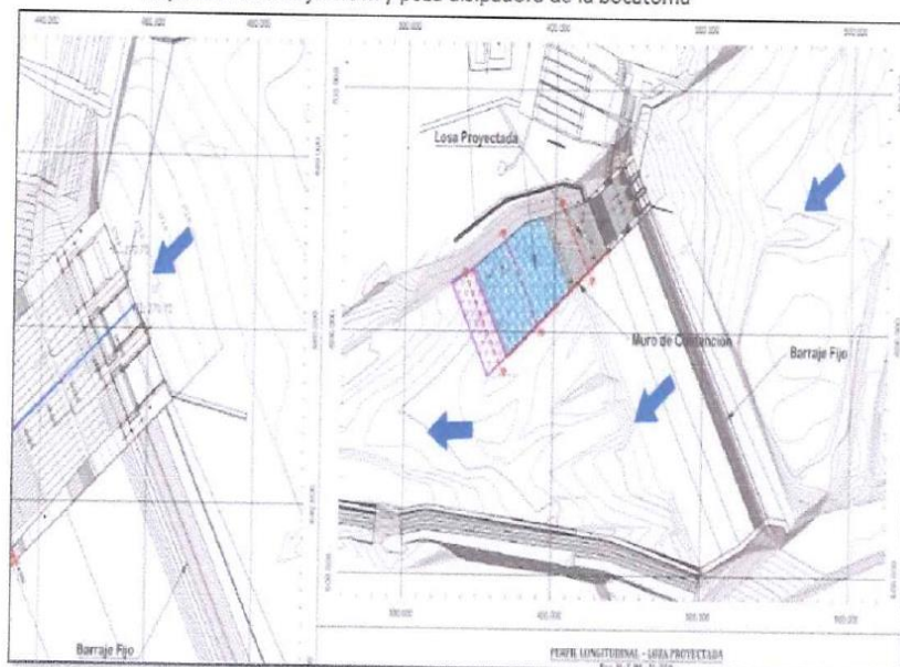
Grafico N° 01 Esquema de barrage móvil y poza disipadora de la bocatoma
