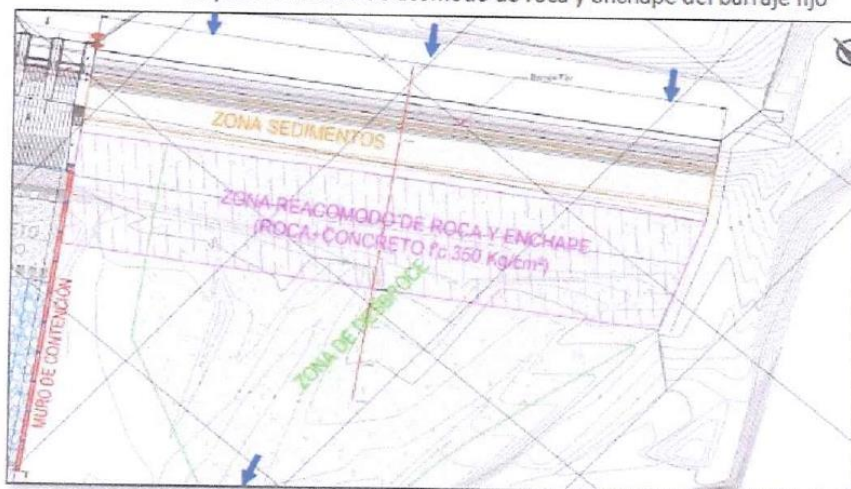
Grafico N° 03 Esquema de zona de acomodo de roca y enchape del barraje fijo
