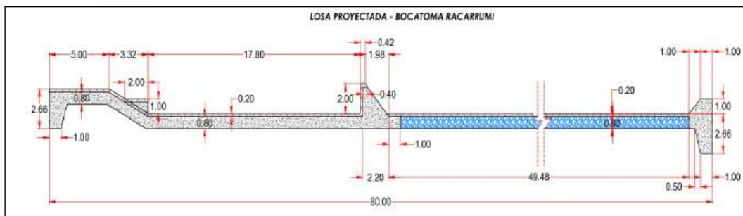
Gráfico N° 02 Esquema de losa proyectada de la bocatoma Racarumi
