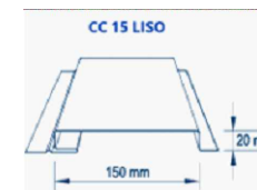
DETALLE 04 - CENEFAS O TAPA CANTO PARA EL PERIMETRO DE LA COBERTURA DE ALUZINC Y EL PANEL LISO - ESCALA 1/100
