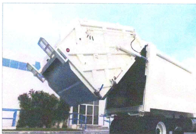
Fotografía N° 11: Descarga de caja compactadora
