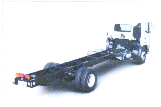
Fotografía N° 03: Chasis Camión 4x2
