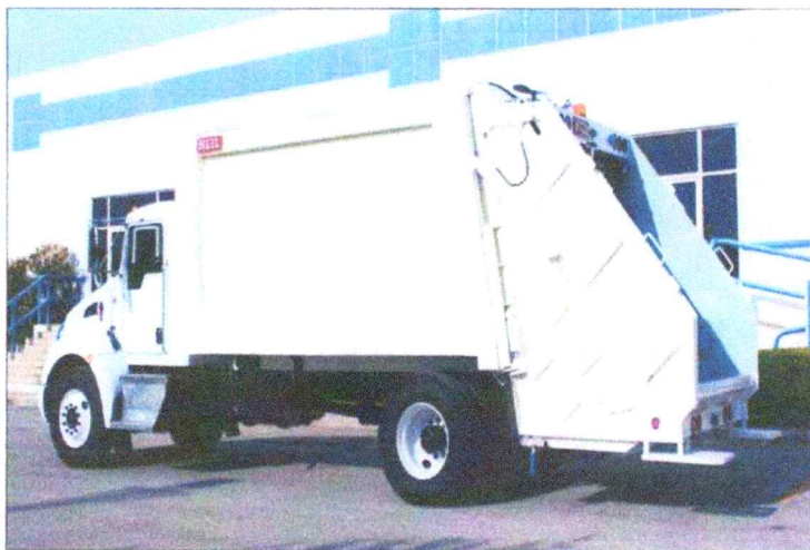
Fotografía N° 10: Caja compactadora de residuos solidos
