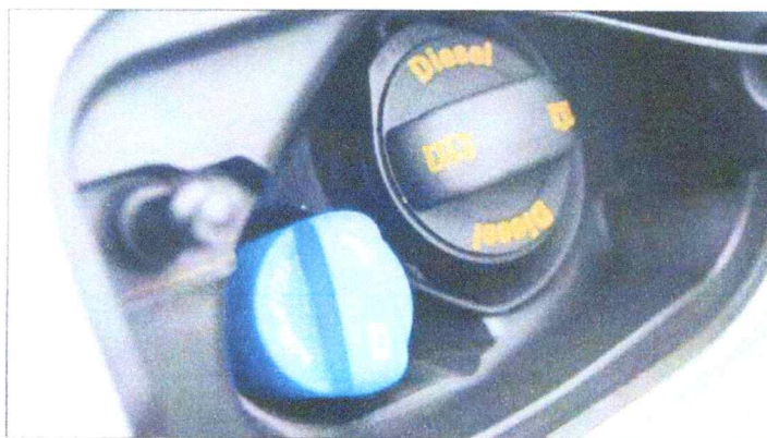
Fotografía N° 02: Tanque de combustible Diésel y Ad Blue
