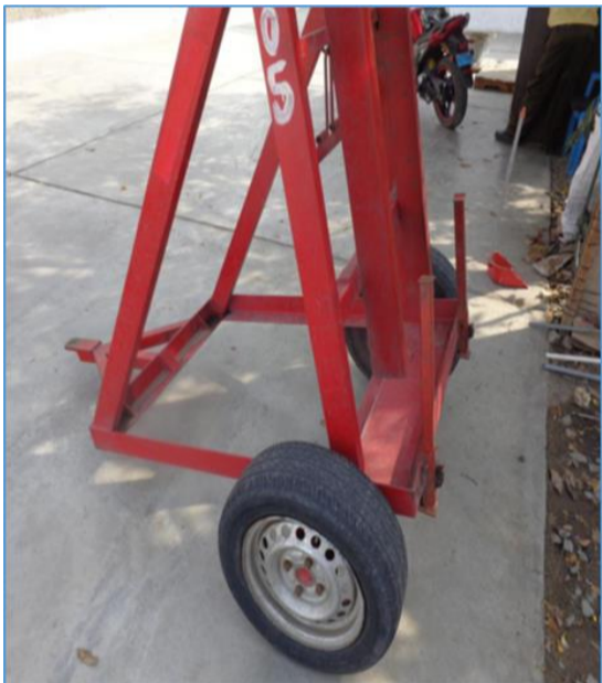
Foto referencial de remolque porta escalera para trabajos a medio vano
