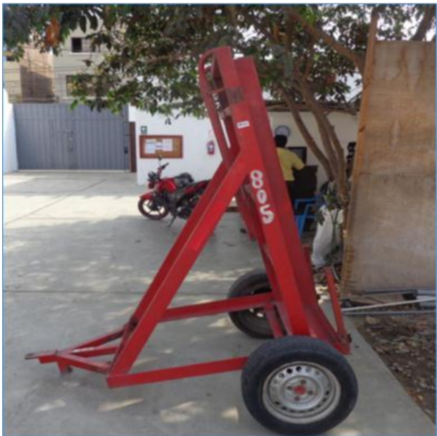
Foto referencial de remolque porta escalera para trabajos a medio vano
