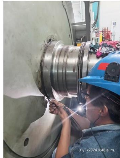
Vista: Utilizando calibrador de laminas, se efectua medición del entrehierro entre el diámetro externo del eje principal turbina – alternador y, el diámetro interno de la volante de inercia.
