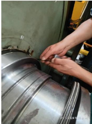
Vista: Verificando el juego circunferencial entre el diámetro externo del eje principal turbina – alternador y, el diámetro interno de la volante de inercia.
