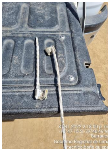
Neutro deteriorado.
