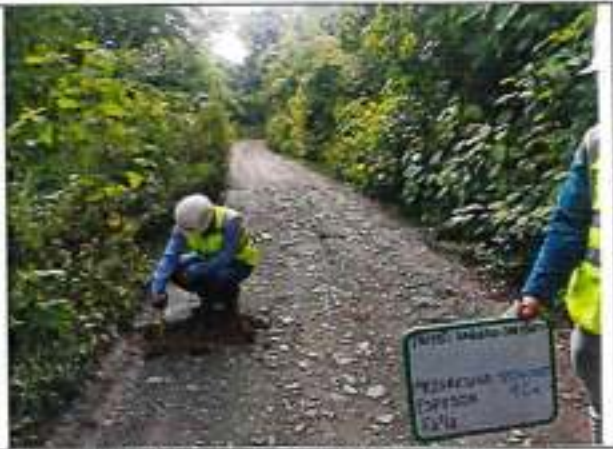
Foto 44: ESPESOR DE AFIRMADO EXISTENTE 9cm - km.80+260
