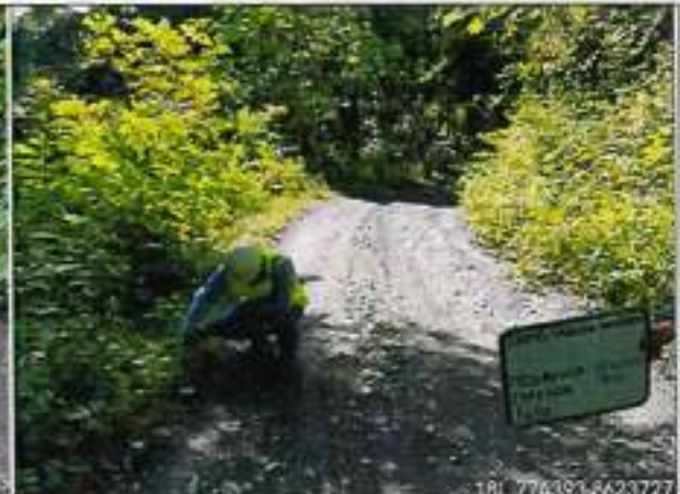
Foto 32: ESPESOR DE AFIRMADO EXISTENTE 9cm - km.77+290
