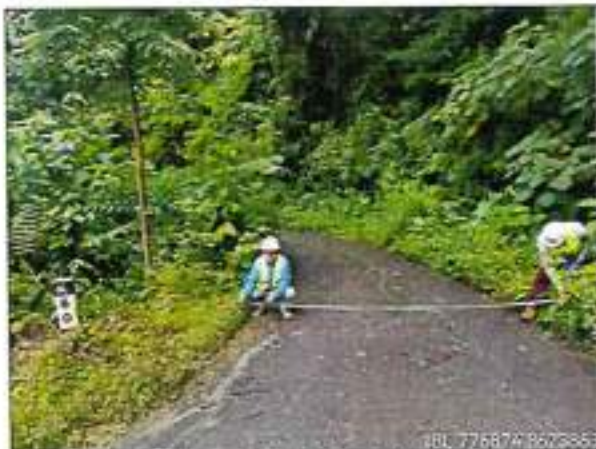
Foto 43: ANCHO DE PLATAFORMA 3.50m - km.80+360.
