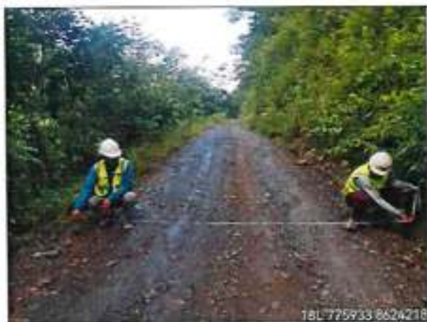
Foto 39: ANCHO DE PLATAFORMA 3.50m - km.79+250.
