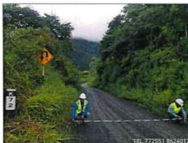
Foto 11: ANCHO DE PLATAFORMA 4.00m - km.72+340.
