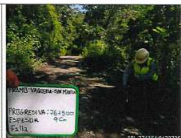
Foto 30: ESPESOR DE AFIRMADO EXISTENTE 9cm – km.76+780
