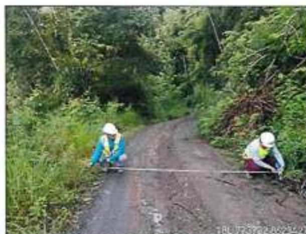
Foto 23: ANCHO DE PLATAFORMA 3.20m – km.75+230.
