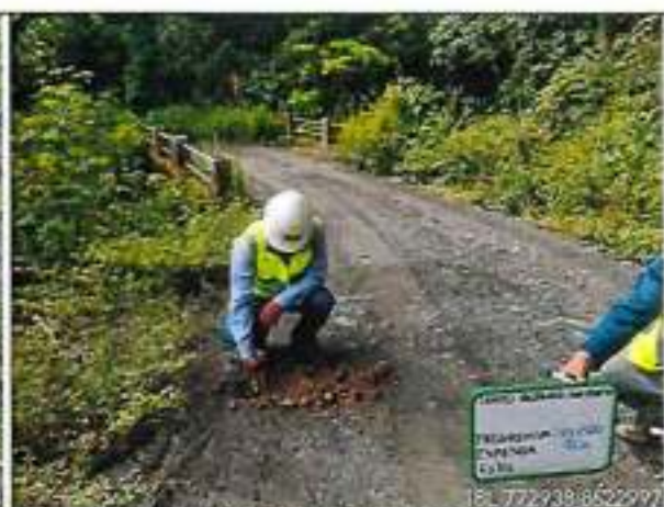
Foto 18: ESPESOR DE AFIRMADO EXISTENTE 9cm - km.73+850
