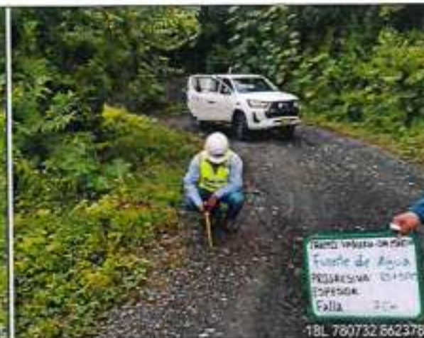
Foto 66: ESPESOR DE AFIRMADO EXISTENTE 7cm - km.85+800
