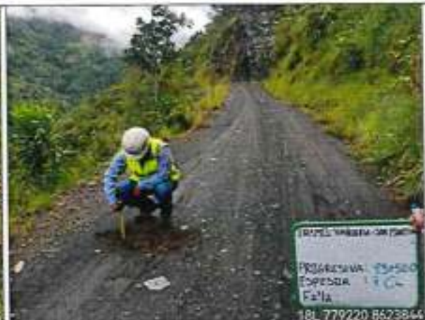
Foto 58: ESPESOR DE AFIRMADO EXISTENTE 8cm - km.83+800
