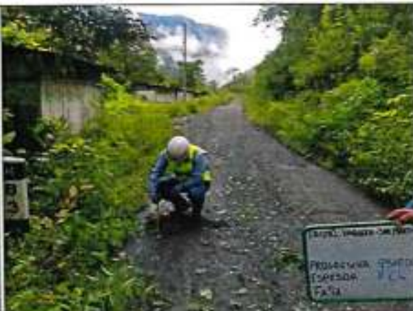
Foto 56: ESPESOR DE AFIRMADO EXISTENTE 8cm - km.83+340
