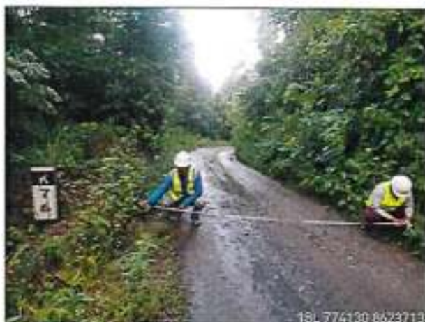
Foto 27: ANCHO DE PLATAFORMA 3.30m – km.76+350.
