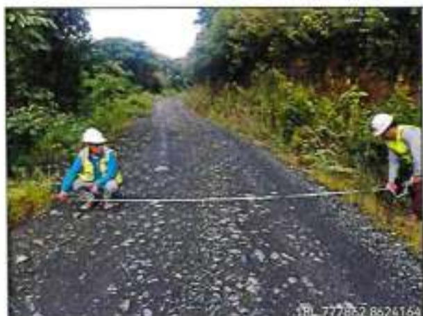
Foto 49: ANCHO DE PLATAFORMA 3.70m – km.81+820.
