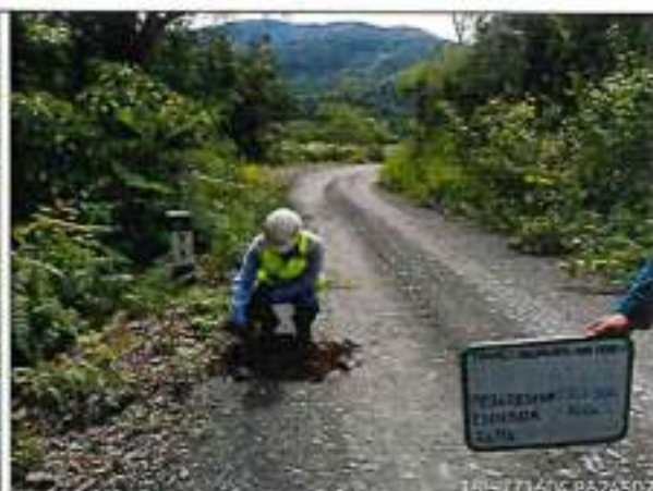
Foto 8: ESPESOR DE AFIRMADO EXISTENTE 10cm - km.71+000
