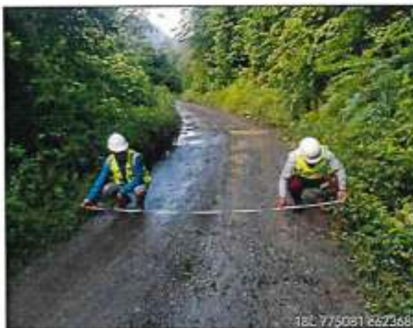
Foto 35: ANCHO DE PLATAFORMA 3.50m - km.78+130.
