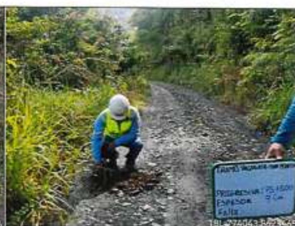
Foto 26: ESPESOR DE AFIRMADO EXISTENTE 9cm – km.75+800
