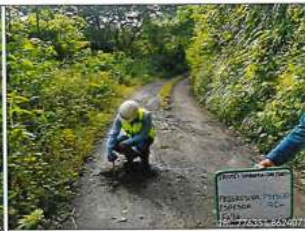
Foto 42: ESPESOR DE AFIRMADO EXISTENTE 9cm - km.79+730
