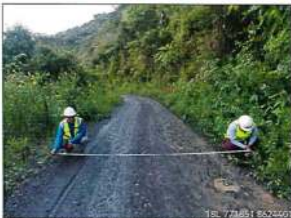
Foto 7: ANCHO DE PLATAFORMA 3.80m - km.71+320.
