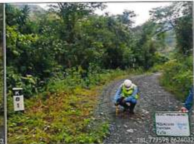
Foto 48: ESPESOR DE AFIRMADO EXISTENTE 9cm - km.81+340
