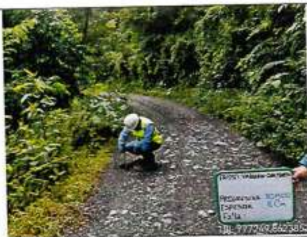
Foto N°02: CU-104_Espesor de afirmado existente_km. 80+790.
