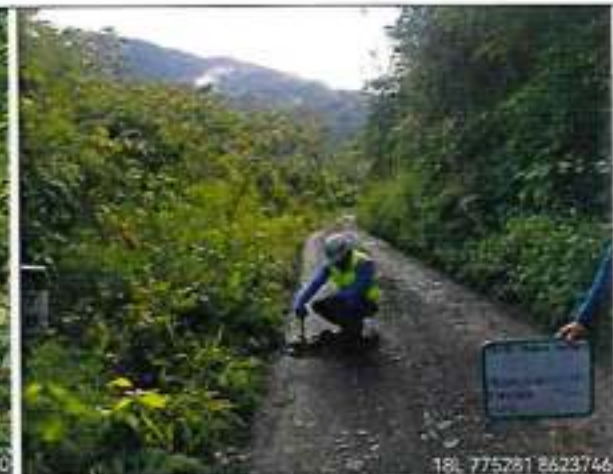
Foto 36: ESPESOR DE AFIRMADO EXISTENTE 9cm - km.78+340
