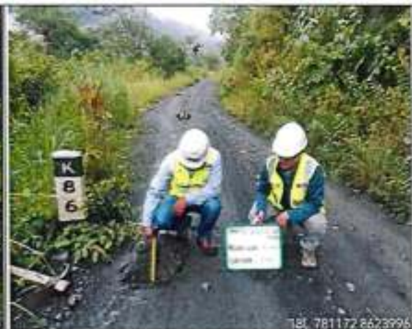
Foto 68: ESPESOR DE AFIRMADO EXISTENTE 8cm - km.86+340
