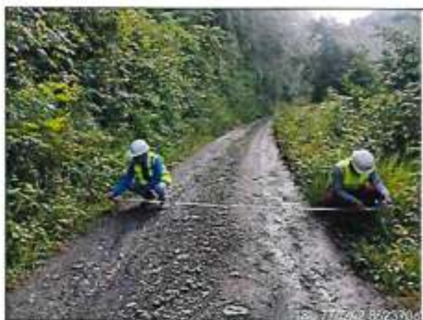
Foto 29: ANCHO DE PLATAFORMA 3.10m – km.76+700.
