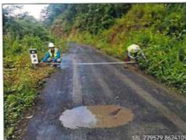
Foto 59: ANCHO DE PLATAFORMA 3.50m - km.84+340.
