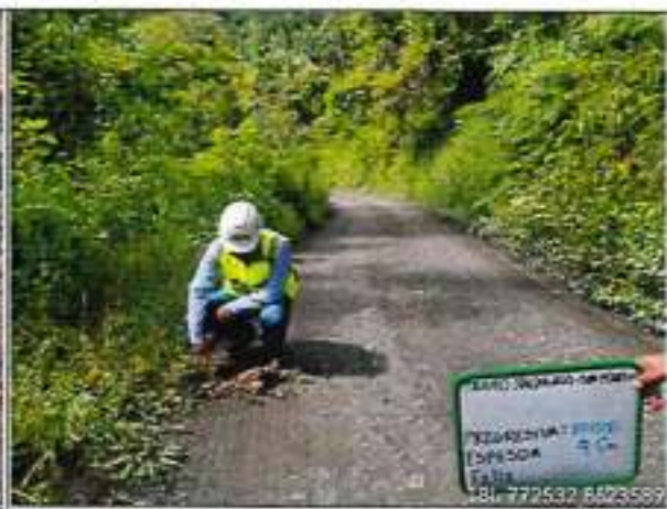
Foto 14: ESPESOR DE AFIRMADO EXISTENTE 9cm - km.72+820
