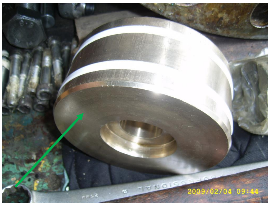
Fotografía 15: Pistón de bronce del vástago (aguja pelton) con anillos shamban con junta torica.
