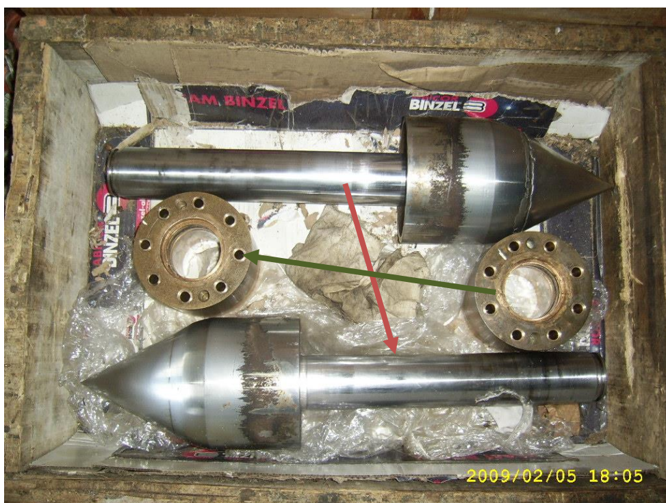
Fotografía 9: Vástagos (aguja pelton) y émbolos obturadores del actuador hidráulico
