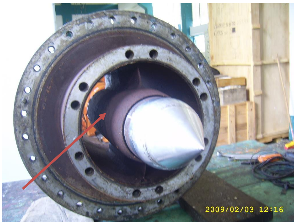
Fotografía 5: Cilindro y vástago (Aguja pelton) .
