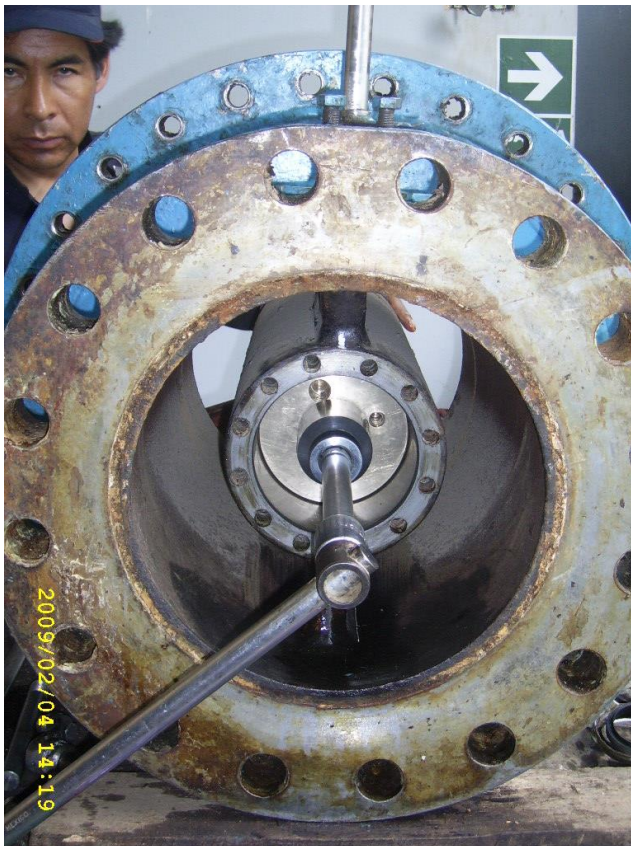
Fotografía 18: Ensamblaje del pistón de bronce sobre el vástago (aguja peltón) y dentro del cilindro.
