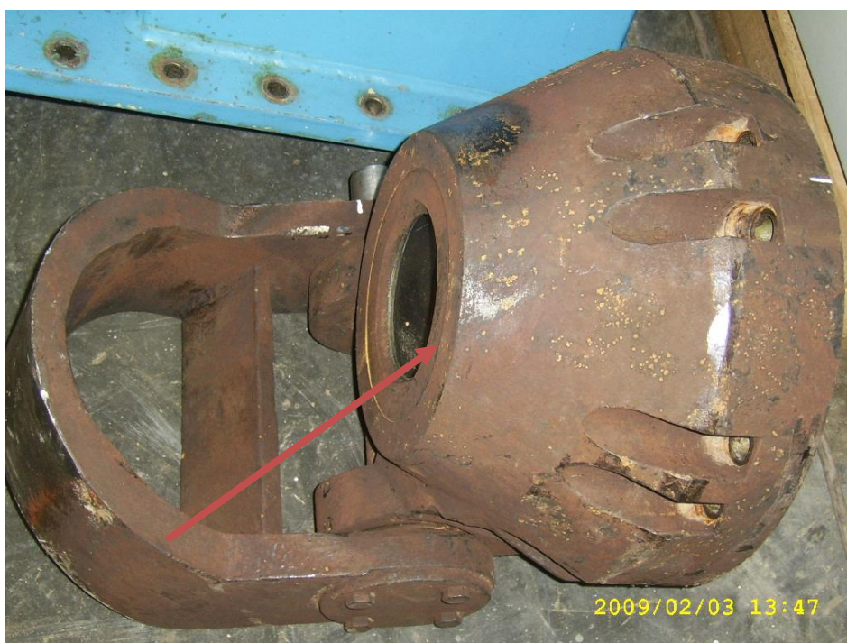
Fotografía 8: Tapa del actuador hidráulico con asiento de aguja pelton
