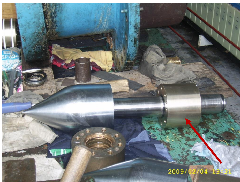
Fotografía 11: Embolo obturadores de bronce montado sobre el vástago (aguja peltón)
