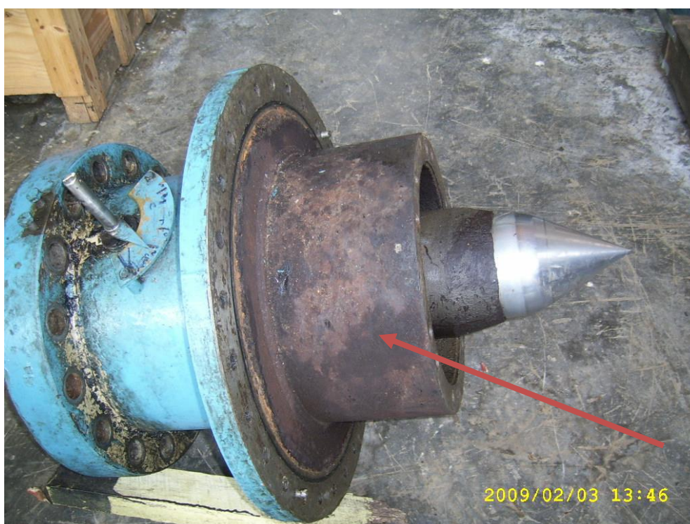
Fotografía 4: Actuador Hidráulico con cilindro de simple efecto (Ensamblado)
