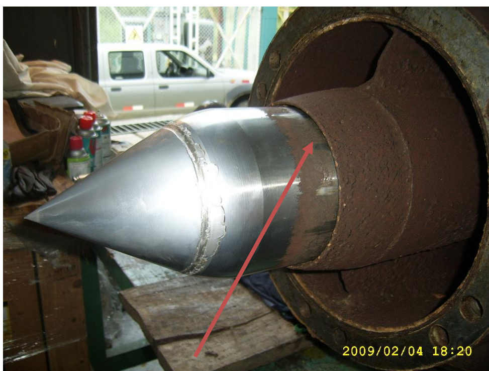
Fotografía 10: Vástago (aguja pelton) dentro del cilindro
