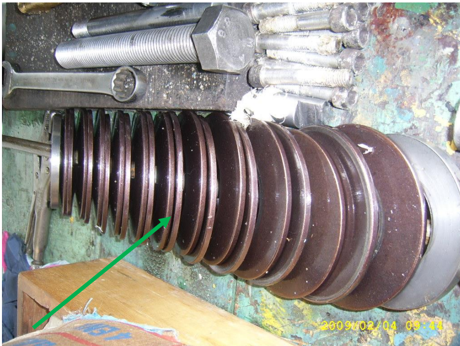
Fotografía 14: Muelles de disco del actuador hidráulico con cilindro de simple efecto.
