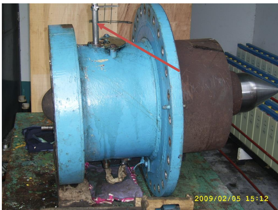
Fotografía 7: Eje del indicador de posición del vástago (Aguja pelton)
