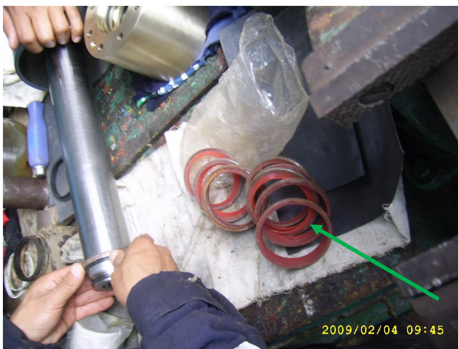
Fotografía 12: Sellos mecánicos (reten) que serán instalados en los émbolos obturadores de bronce.
