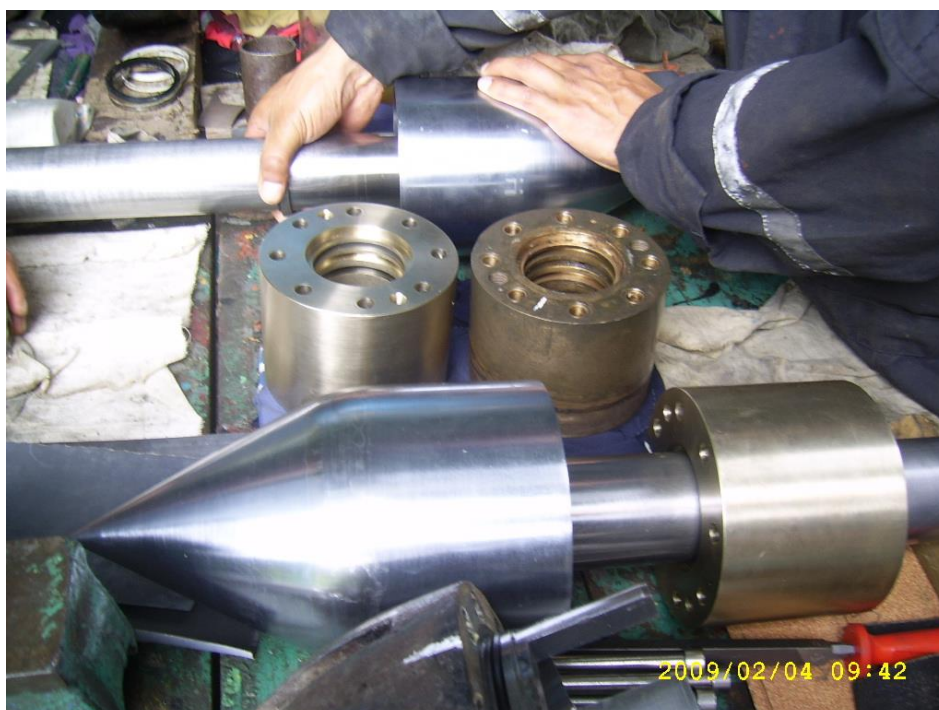
Fotografía 16: Émbolos obturadores de bronce y vástago (aguja peltón)
