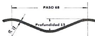
Figura 1. Dimensiones de la corruaga 68 mm x 13 mm
