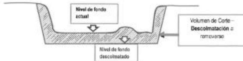
**7.2.5.6. CONFORMACION DE DIQUE CON MATERIAL PROPIO (M3)**
