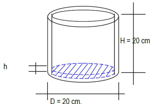
Para medir la cantidad de agua, se deberá introducir una regla milimetrada de madera en el centro del balde y se procederá a la medición respectiva.
